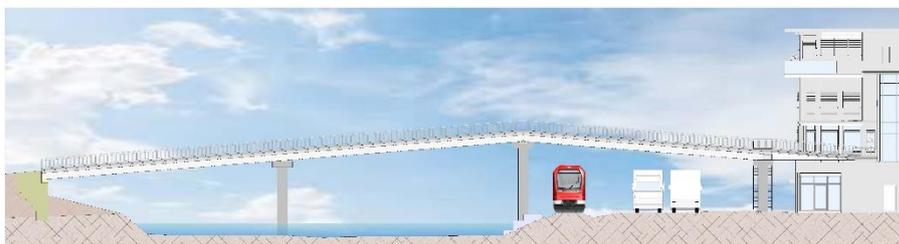
Schematische Zeichnung zum Aufbau der neuen Fußgängerbrücke am WEPA Standort Müschede
